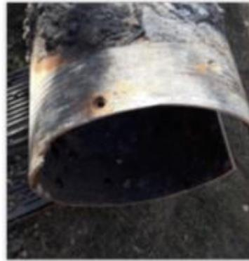
◆ Metz, Rue d'Asfeld : rupture sur canalisation DN 350 le 19 octobre 2018
