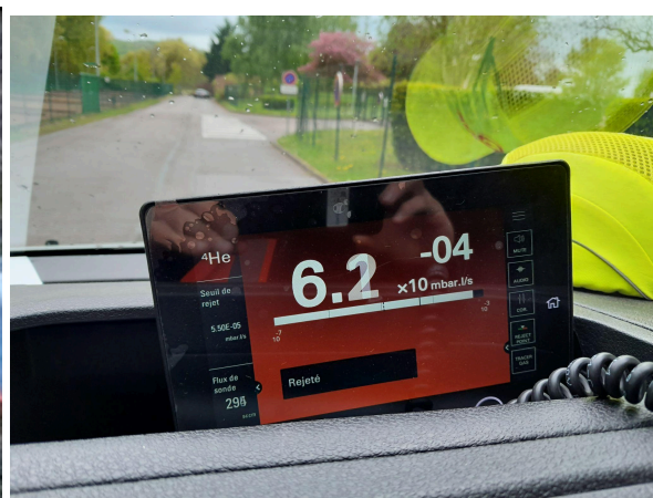
Fuite branchement rue de l'hôte à Plappeville, fuite sur PI rue de la Moselle à Ars sur Moselle, fuite canalisation rue des 100 livres, détection positive avec notre outil
